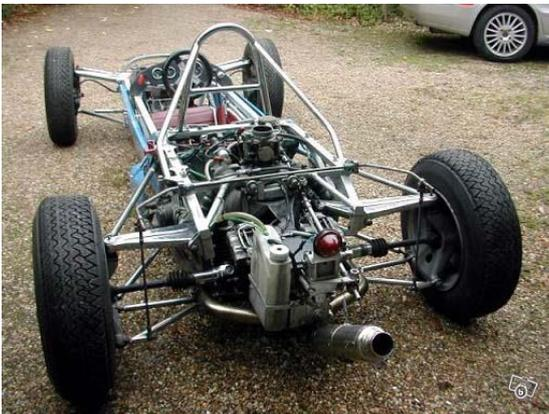
Ce qui est stabilisé à partir de la carrosserie fait partie des masses non suspendues : suspensions et amortisseurs, roulements éléments de direction, freins et enfin le pneu. Ce dernier en final doit s'insérer harmonieusement dans cet ensemble.
