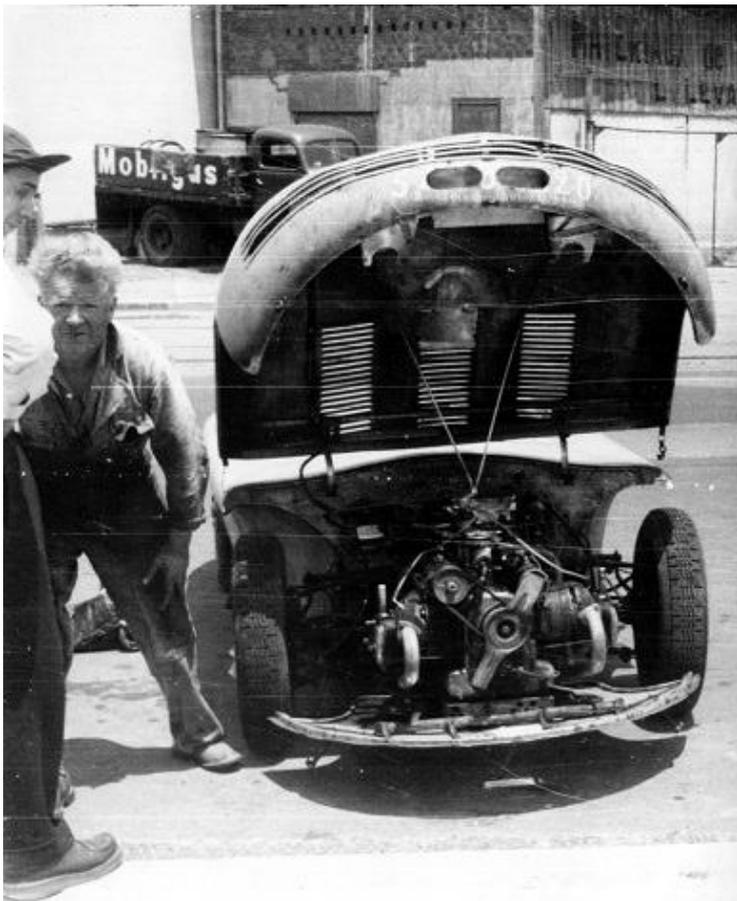
Une seconde coque moins généreusement calculée, 2,5 mm d'épaisseur seulement et 45 kg sera par la suite réalisée. Avec cet excellent rapport poids/puissance, cet engin pouvait atteindre les 160 km/h avec des accélérations tout à fait remarquables.
